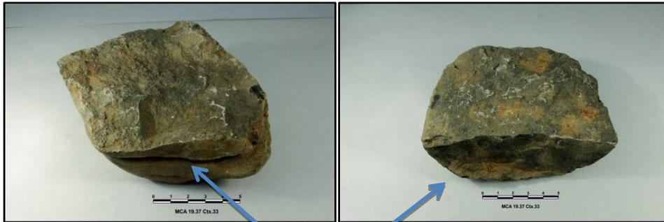
*Rotura en sección completa*
